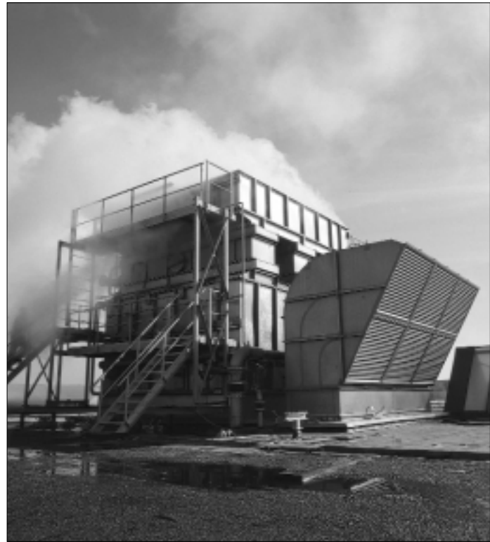
Afbeelding 8: uitlaat scrubber, inlaat droogkap in de papierindustrie
