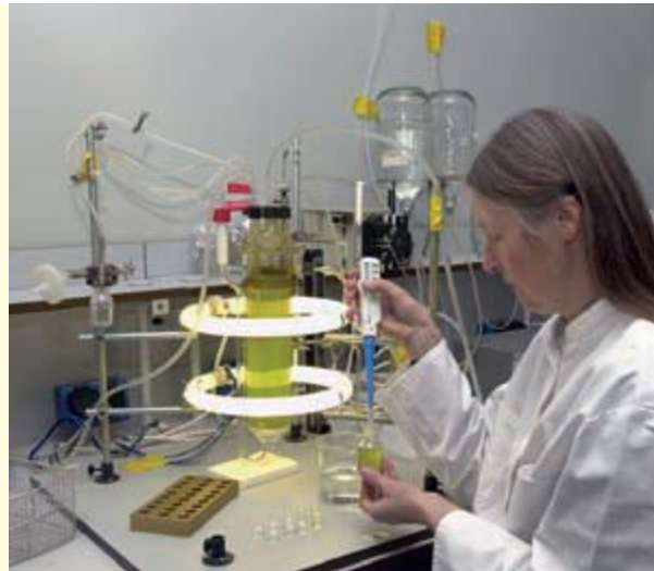
Toxiciteitstest met algen (PAM-fotosynthesetest) - voorbeeld van een bioassay in stap 2 van de TRIADE (foto: RIVM).
