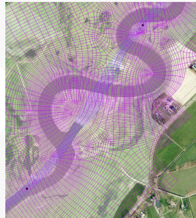
Links: het nieuwe rooster aangepast aan een van de projecten van Ruimte voor de Vecht met op de achtergrond een recent satellietbeeld (blauwe polygoon in het midden is het oude zomerbed). Midden en rechts: de vergelijking van de tijdstap in seconden in 2D D-Flow FM model van de j19- en de j24-versie uit drie verschillende standaardsommen met dynamische afvoergolven.
