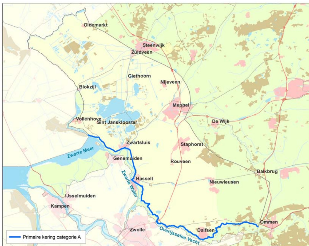
Figuur 11: Overzicht ligging primaire waterkering van de categorie a van dijkkring 9.
