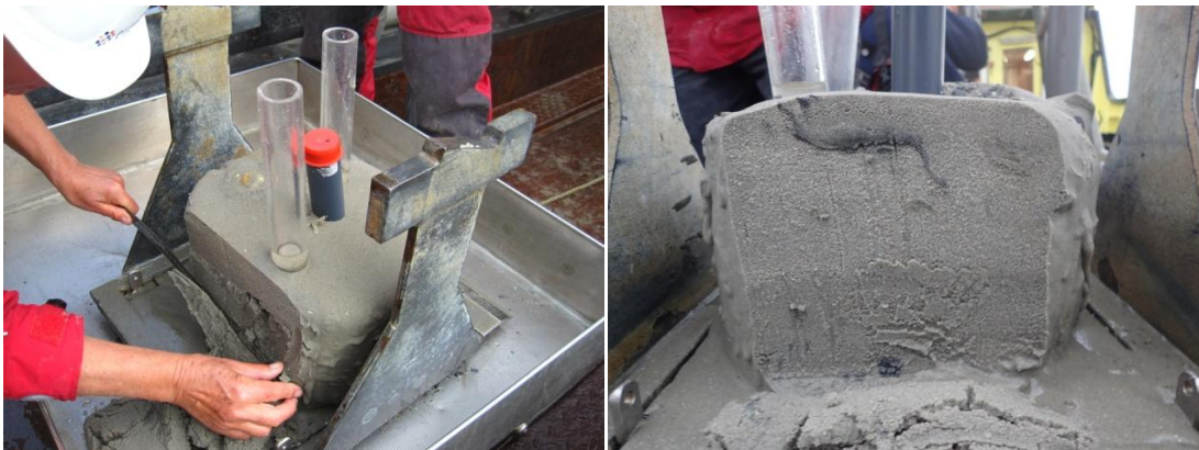
Figuur 2-3: Sedimentbemonstering met steekbuizen en foto van zijaanzicht van een monster.
