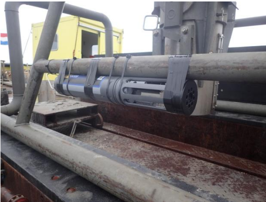
Figuur 2-4: CTD meter bevestigd aan de boxcorer (foto Harriette Holzhauer)
