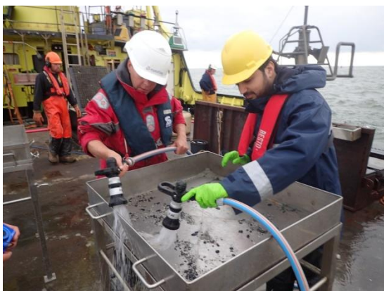
Figuur 2-2: Zeeftafel met zeef (1 mm) en sproei-installatie (foto Harriette Holzhauser)
