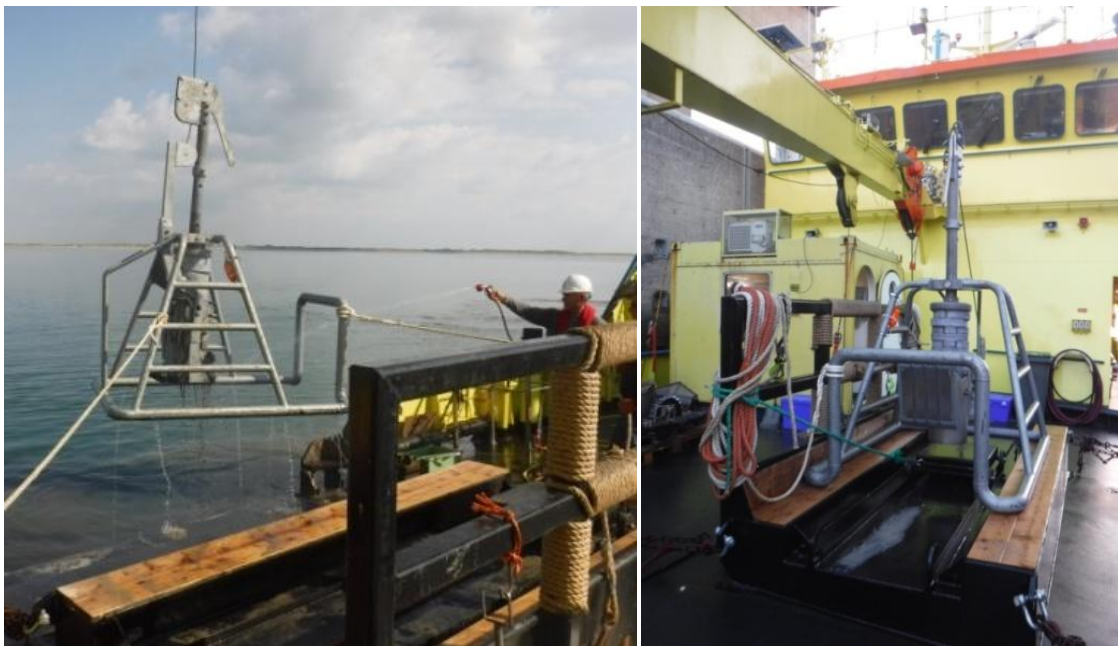
Figuur 2-4 Reineck-boxcorer in combinatie met L-frame (uit: Veld en analyserapportage 2016; Stolk et al (2017) )
