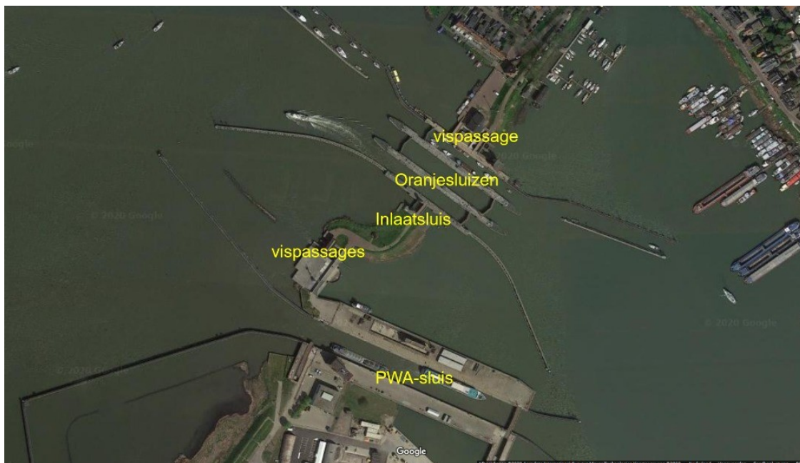
Figuur 3.3 Ligging Oranjesluizen, inlaten en vispassages
