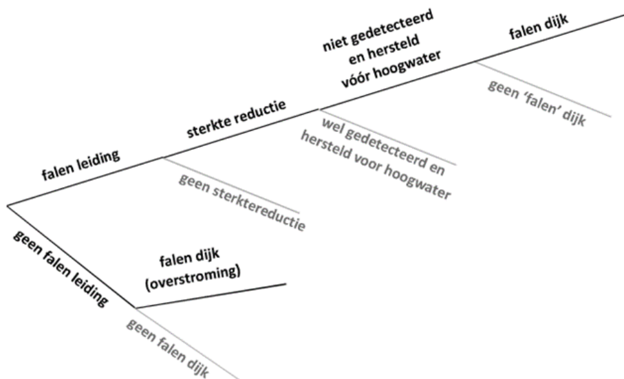
Figuur 5: Generieke faalpaden voor falende leidingen (Bron: WBI Veiligheidsraamwerk Kabels en Leidingen)
